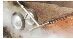
Spezial-Zubehör für chemiefreie Unkrautbekämpfung mit Heisswasser, welches kurz vor der Dampfstufe austritt.
